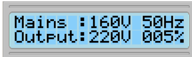
Şebeke Gerilimi-Frekansı, Çıkış Gerilimi-Yük Yüzdesi Bilgileri
